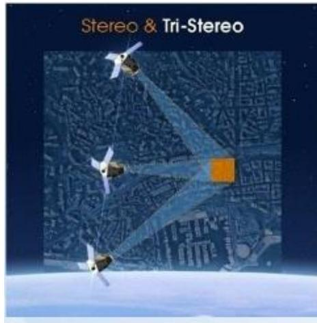
Les données stéréoscopiques sont traitées à l'aide d'algorithmes de photogrammétrie pour produire les DSM
