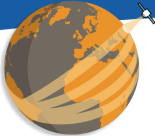
La largeur de la bande de surface visible par le satellite est appelée la **fauchée**. Les satellites ayant différentes tailles de fauchée ont donc différentes résolutions temporelles (en fonction du mode d'acquisition). Ainsi, les satellites ayant une fauchée large ont une résolution spatiale plus basse, mais une fréquence de revisite élevée de revisite.
