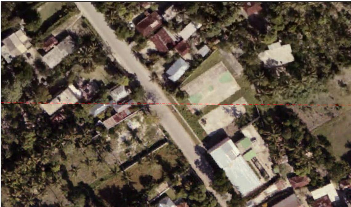
Figure 4: Exemple de mauvais assemblage des tuiles (tirets rouges) de l'ortho-photo 2014 sur le secteur de Port-Salut.
